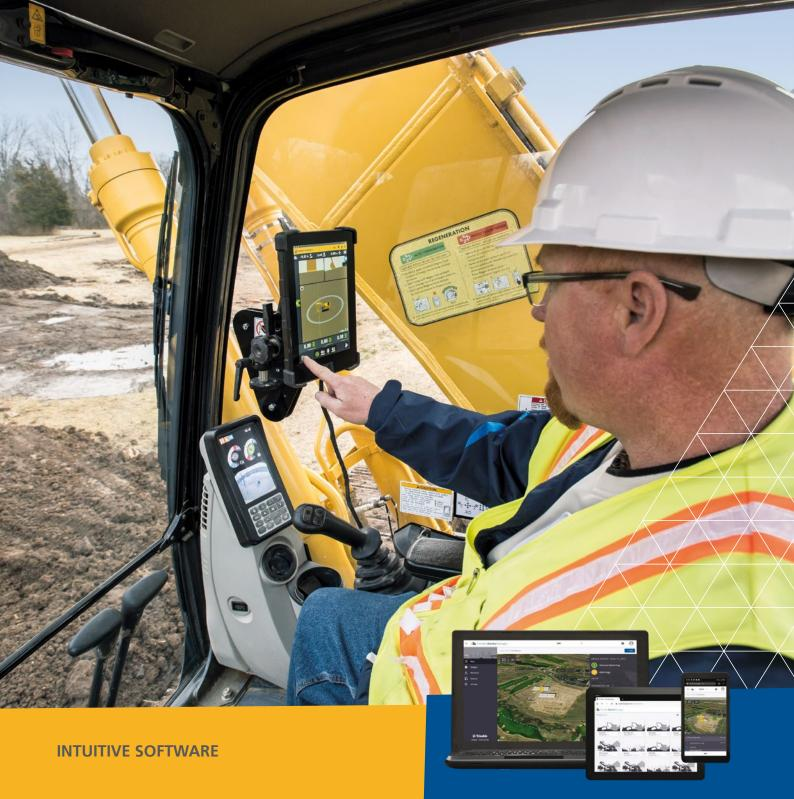
Die Earthworks-App für Android bietet dem Fahrer eine optimierte Benutzeroberfläche mit der er eine maximale Arbeitsleistung der Maschine erreicht.
