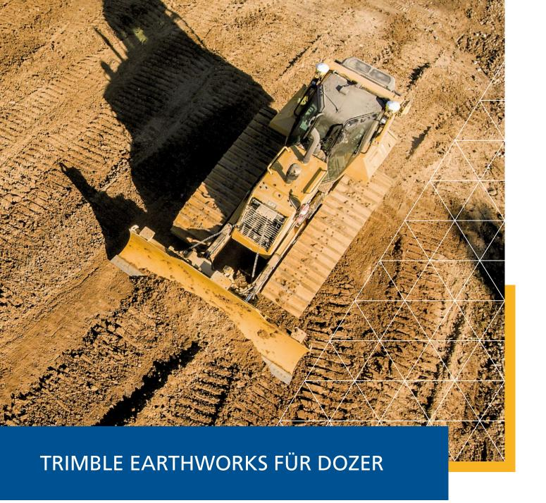
Die neueste Version der Maschinensteuerung Trimble Earthworks für Dozer unterstützt die meisten Maschinentypen der führenden Hersteller. Verfügbar sind 3D-Konfigurationen mit Universal-Totalstation und GNSS sowie die Lasersteuerung für den 2D-Betrieb. Die neue Version ermöglicht die Montage der GNSS-Empfänger auf der Kabine sowie auf dem Schild. Insbesondere mit der neuen Richtungsautomatik werden deutliche Produktivitätsvorteile erzielt.
