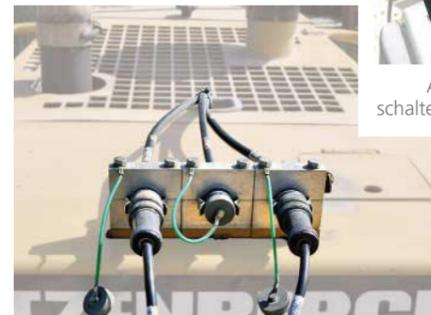
Steckverbindungen für Spiralkabel
