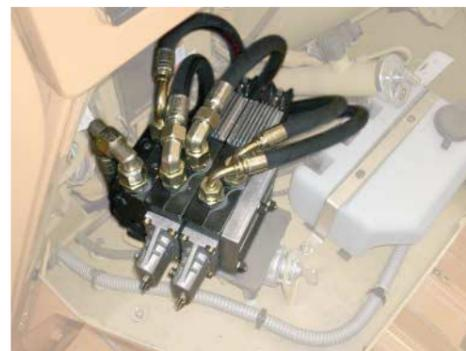
Proportional-Hydraulikventil und Schlauchkit
