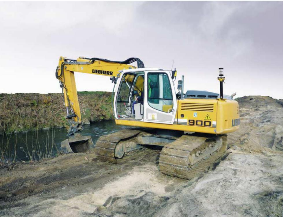
Die 3D-Steuerungsvariante mit UTS kommt vor allem bei den Anwendungen zum Einsatz, bei denen eine permanent hohe Genauigkeit erreicht werden soll. Die UTS-Steuerung ist vor allem für kleinere Baumaßnahmen geeignet und damit für Bauunternehmer, die ihre Maschinen häufig sehr kurzfristig auf verschiedenen Baustellen zum Einsatz bringen. Aufgrund der einfachen Handhabung kann dieses System von den Maschinisten täglich selbstständig in Betrieb genommen werden.
