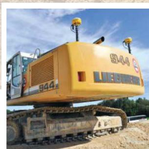
GNSS-Empfänger mit integrierter Antenne MS 992 (Zwei-Mast-System)
