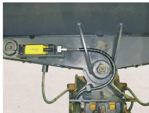
Schwenklöffelkontrolle mit Winkelsensor AS 450 in einem robusten Stahlschutzgehäuse
